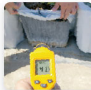
Temperatura de la maceta con falda de enfriamiento levantada.
