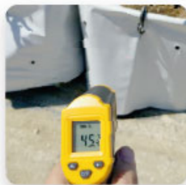
Temperatura de la maceta con falda de enfriamiento.
